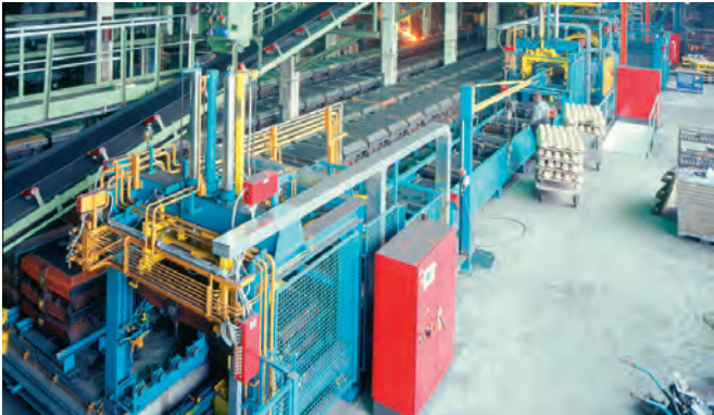
HWS-Hochdruckpress-Formanlage Formvolumen 900 x 800 x 600 mm Vollautomatisiert
