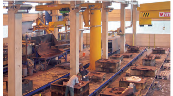
Kaltharz-Formanlage, Formvolumen 2200 x 1600 x 1500 mm
