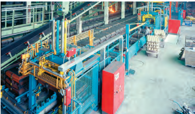
HWS-Hochdruckpress-Formanlage Formvolumen 900 x 800 x 600 mm Vollautomatisiert
