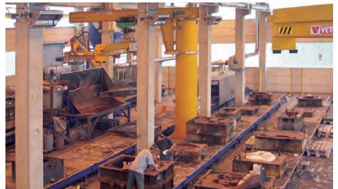
Kaltharz-Formanlage, Formvolumen 2200 x 1600 x 1500 mm
