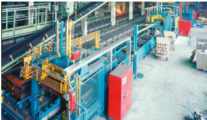
HWS-Hochdruckpress-Formanlage Formvolumen 900 x 800 x 600 mm Vollautomatisiert
