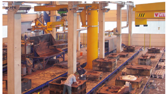
Kaltharz-Formanlage, Formvolumen 2200 x 1600 x 1500 mm
